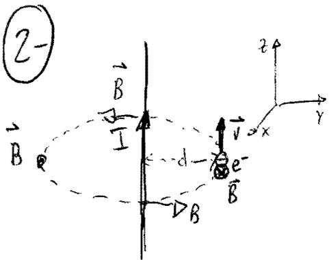
a) EL CAMPO MAGNÉTICO CREADO POR UN HILO CONDUCTOR RECTILÍNEO E INDEFINIDO, ES TANGENTE A LAS LÍNEAS DE CAMPO (CIRCUNF. CONCÉNTRICAS AL HILO) Y SU SENTIDO VIENE DETERMINADO POR LA REGA DE LA MANO DERECHA. SU MÓDULO SE HALLA:
